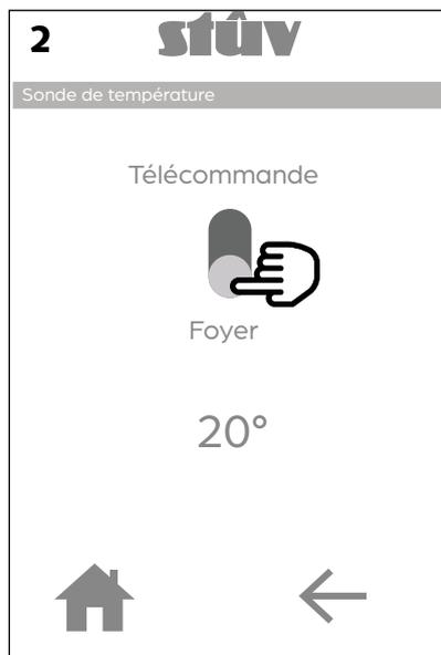
Permet de sélectionner la sonde de température de la télécommande ou du poêle pour la mesure de la température ambiante.
